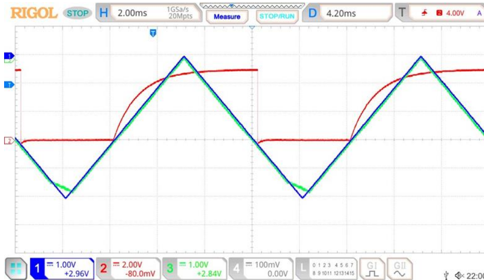
Рисунок 1. Диаграмма напряжений: сигнал подстройки напряжения смещения ADJ1 (канал1, синий), сигнал на первом выходе напряжения смещения (канал 3, зелёный), сигнал контроля напряжения смещения первого выхода (2 канал, красный)
