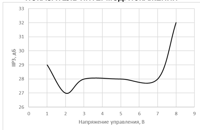
Рисунок 9 – входная мощность в точке пересечения интермодуляции 3-го порядка
