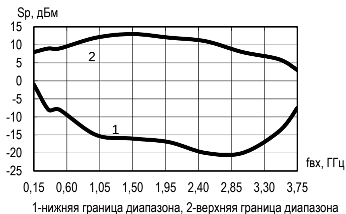
Зависимость мощности второй и третьей гармоники в выходном сигнале от частоты входного сигнала ( U_{п} = 5 В , P_{вх} = 0 дБм )
