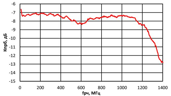
Зависимость коэффициента преобразования от частоты ПЧ
