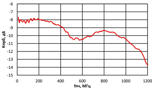
Зависимость коэффициента преобразования от частоты ПЧ
