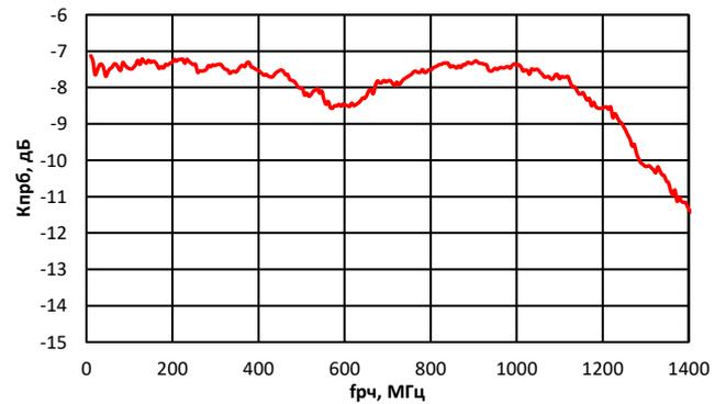
Зависимость коэффициента преобразования от частоты ПЧ
