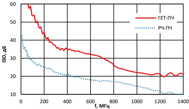
Зависимость изоляции ГЕТ-ПЧ, РЧ-ПЧ от частоты
