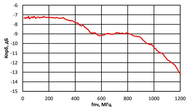
Зависимость изоляции ГЕТ-ПЧ, РЧ-ПЧ от частоты
