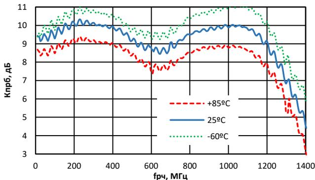
Зависимость коэффициента преобразования от частоты РЧ
