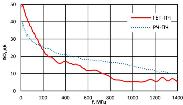
Зависимость изоляции ГЕТ-ПЧ, РЧ-ПЧ от частоты
