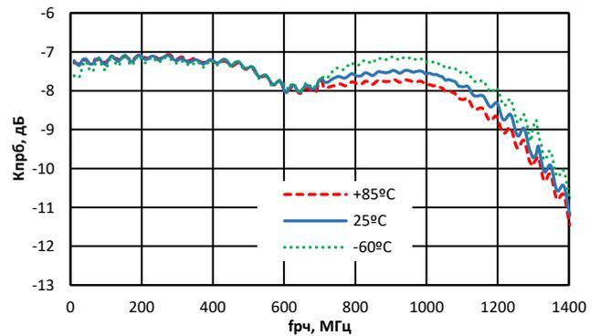
Зависимость коэффициента преобразования от частоты РЧ
