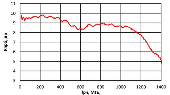
Зависимость коэффициента преобразования от частоты ПЧ
