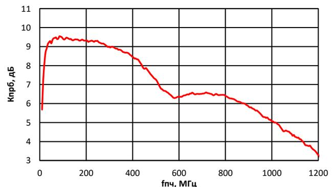
Зависимость изоляции ГЕТ-ПЧ, РЧ-ПЧ от частоты
