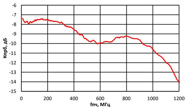
Зависимость коэффициента преобразования от частоты ПЧ
