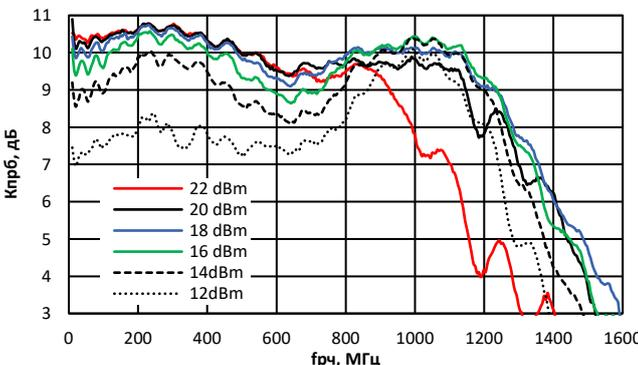
Зависимость мощности при 1 дБ компрессии от частоты РЧ
