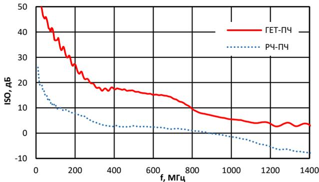
Зависимость изоляции ГЕТ-ПЧ, РЧ-ПЧ от частоты
