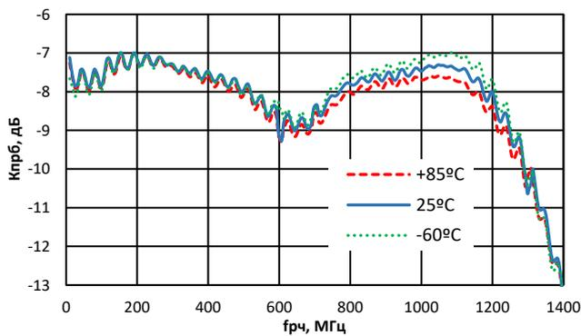
Зависимость коэффициента преобразования от частоты РЧ
