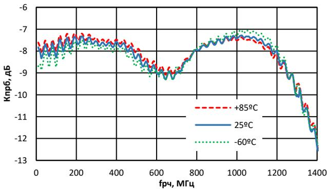
Зависимость коэффициента преобразования от частоты РЧ
