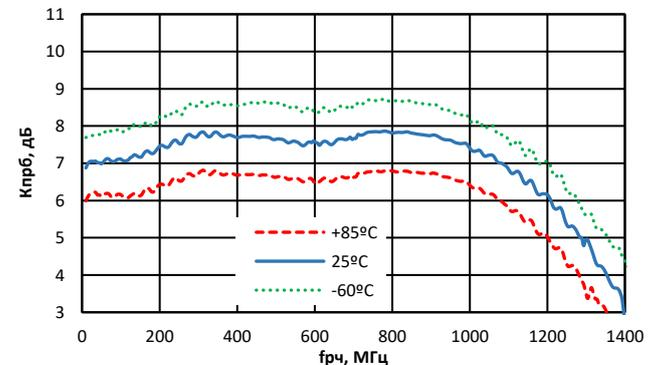
Зависимость коэффициента преобразования от частоты РЧ
