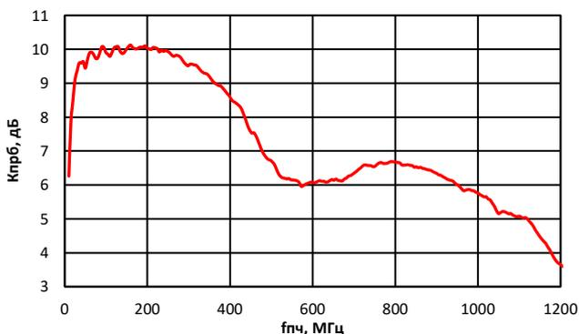
Зависимость коэффициента преобразования от частоты ПЧ
