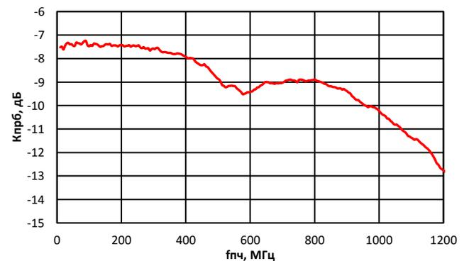
Зависимость изоляции ГЕТ-ПЧ, РЧ-ПЧ от частоты
