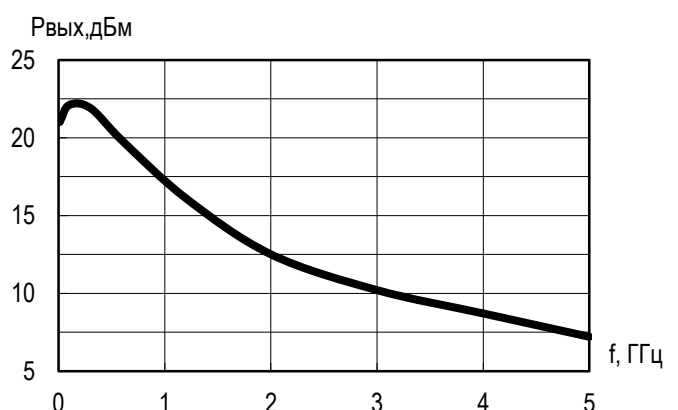
Зависимость выходной мощности от частоты ( U_n = 5 В; I_p = 100 мА; P_{вх} = 6 дБм)
