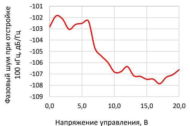
СПМ ФШ ПРИ ОТСТРОЙКЕ 100 КГЦ
