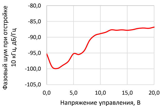
СПМ ФШ ПРИ ОТСТРОЙКЕ НА 10 КГЦ
