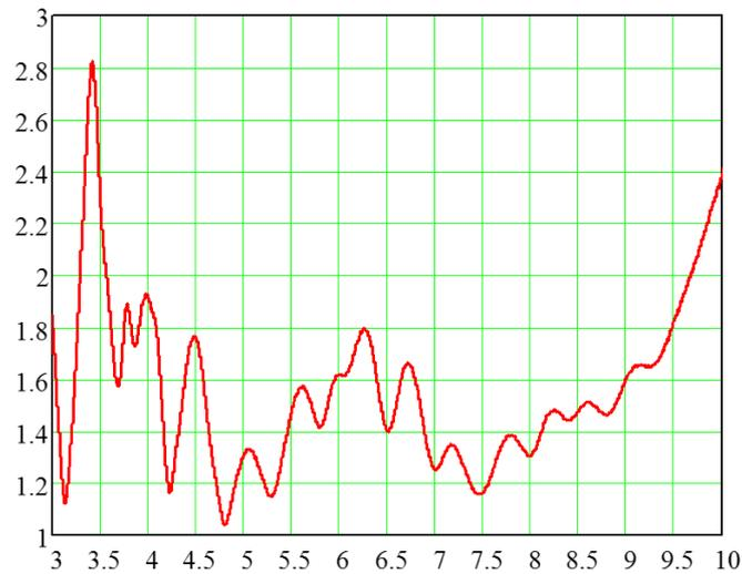
Рис. 4 – Частотная зависимость КСВН спиральной антенны
